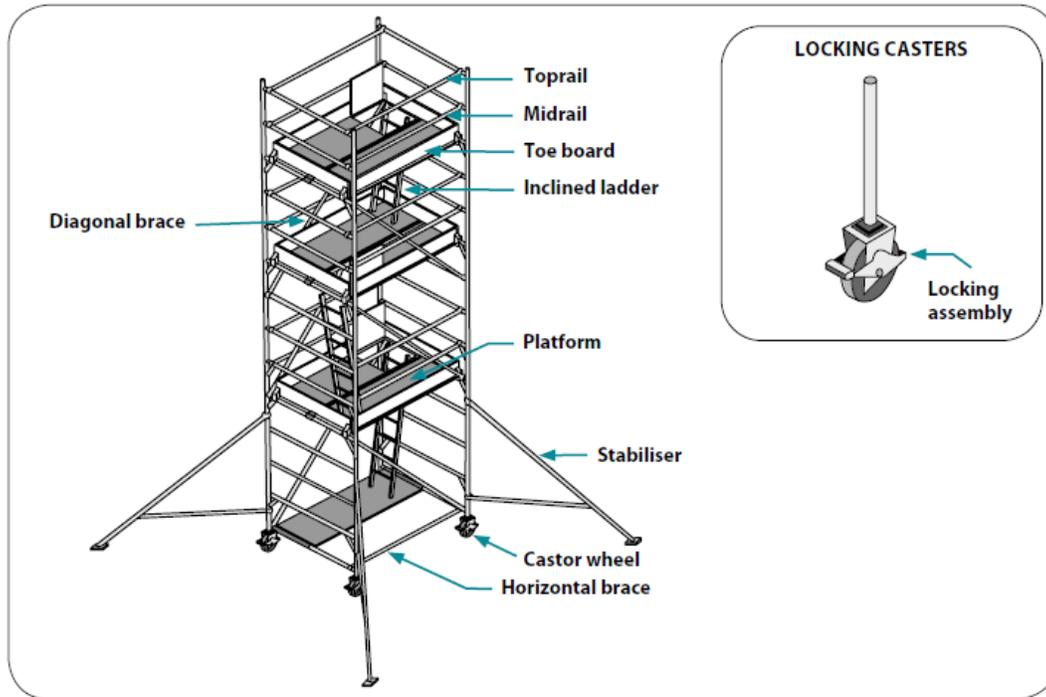
图28 塔式机动脚手架
