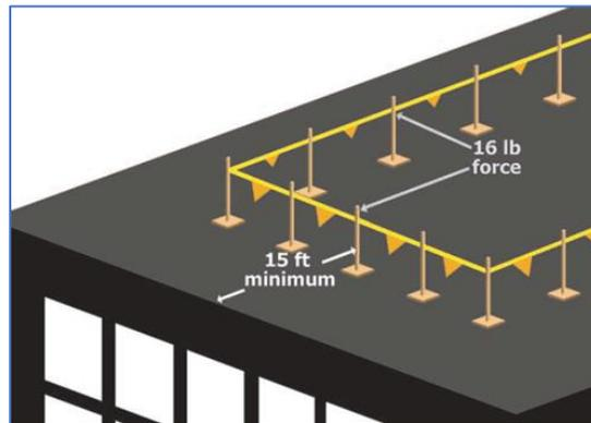
图1 将非标准护栏从边缘处移除
