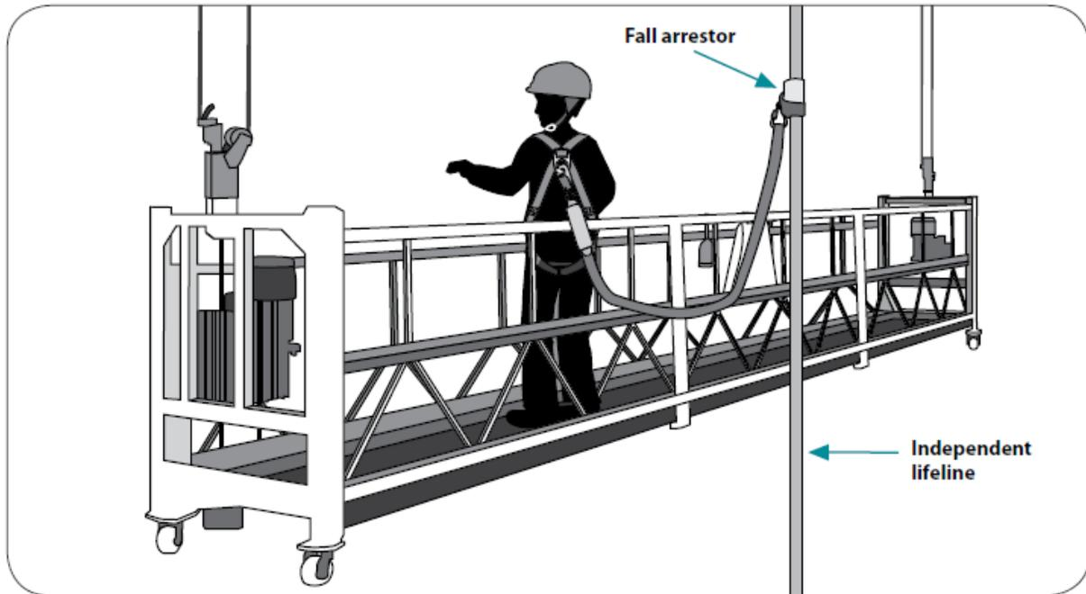
图29 悬吊式脚手架
