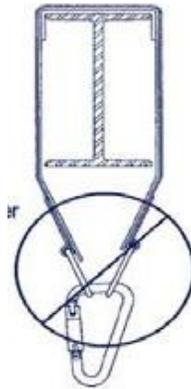
图9 系紧适配器，将小D型环穿过大D型环
