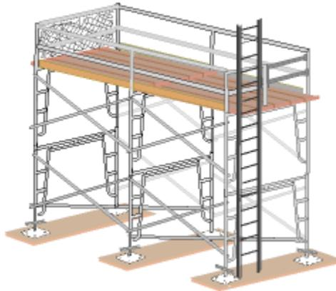
图 27 框架式脚手架
